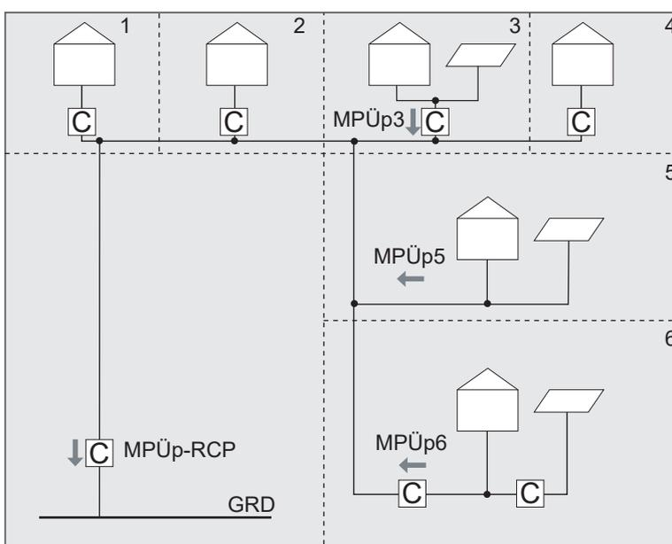
Fig. 5 : Mesure des excédents internes dans le RCP
